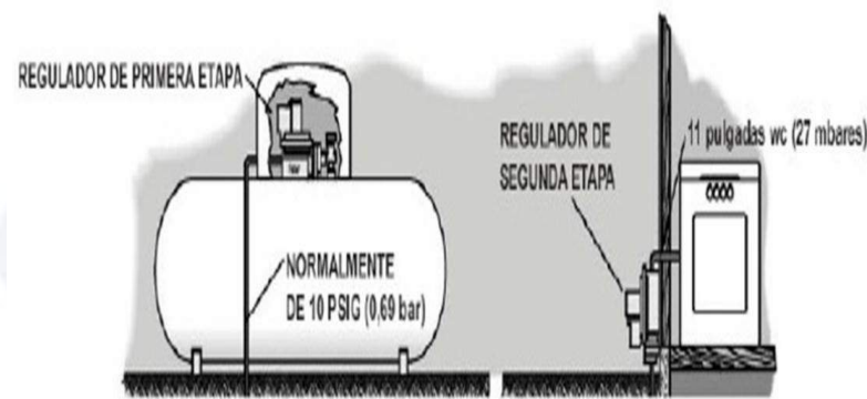
Figura 44.- Posición de reguladores de primera y segunda etapa.
