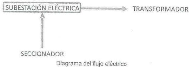
De acuerdo con la composición de la red eléctrica del CISZ, se instalarán 03 (tres) transformadores trifásicos que permiten aumentar o disminuir la tensión en un circuito eléctrico de corriente alterna, manteniendo la potencia cuando es necesario. Estos transformadores ayudan a mejorar la seguridad y eficiencia de los sistemas de energía durante su distribución y regulación.
