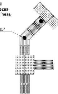
**ESPECIFICACIÓN:** Loseta vibro-prensada prefabricada con textura táctil puntual ó lineal en formato 40 cm x 40 cm x 4 cm de espesor, de uso peatonal, con resistencia a la compresión f'c=250 kg/cm².
