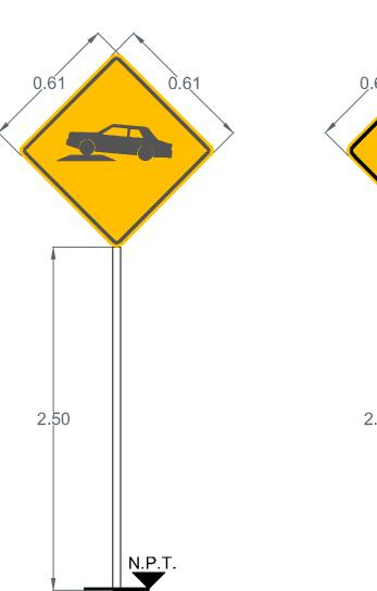
SP-41 reductor de velocidad: velocidad de los vehículos. conforme al sentido vehicular. Ubicar 40 m. Antes del crucero sobre la banqueta derecha conforme al sentido vehicular.
