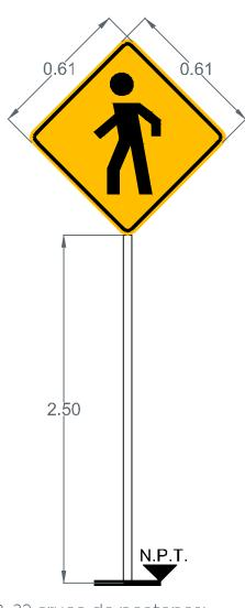
SP-32 cruce de peatones: Se usa para indicar la Se utiliza para indicar los sitios o proximidad de un reductor de zonas de la vialidad por donde velocidad, que es un dispositivo cruzan o transitan peatones. instalado sobre la superficie de Ubicar 40 m. Antes del crucero rodadura para controlar la sobre la banqueta derecha
