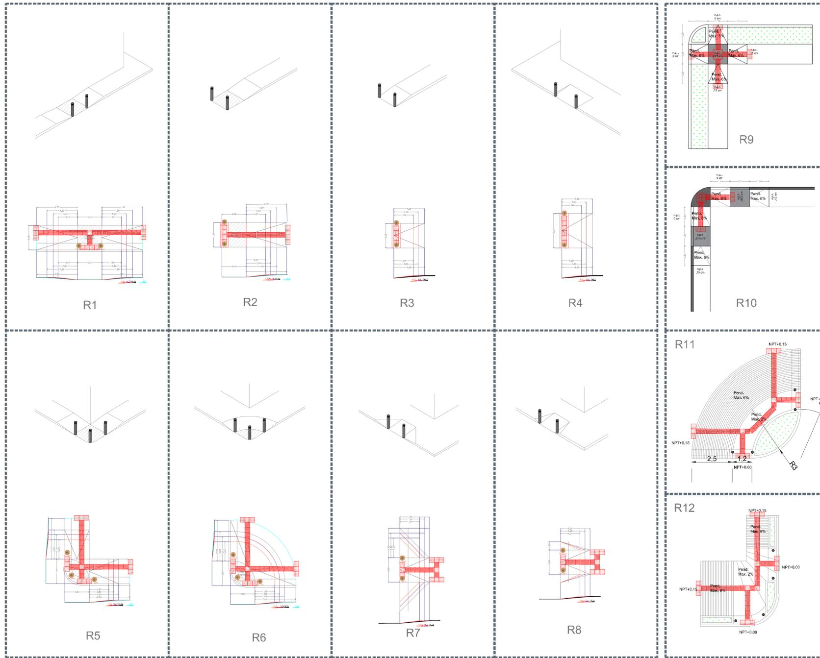
**ESPECIFICACIÓN:** Loseta vibro-prensada prefabricada con textura táctil puntual ó lineal en formato 40 cm x 40 cm x 3.2 cm de espesor, de uso peatonal, con resistencia a la compresión f'c=230 a 260 kg/cm².
