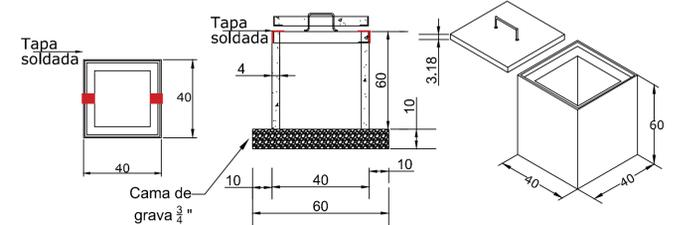
Registro precolado 40X40X60 cm, con marco y contramarco galvanizado por inmersión en caliente. Fabricado con concreto hidráulico F' C= 200 Kg/cm2, registro armado con malla 6X6-10/10 en muro y malla 6X6-6/6 en tapa, muros de 4 cm de espesor con acabado cemento pulido, marco con ángulo de 1-1/2" X 1/4" y espesor de 3.18 cm. Incluye: agarradera para la tapa elaborado en acero redondo de 3/4" galvanizado por inmersión en caliente, rondanas y tuercas de 3/4" galvanizadas para su sujeción.
