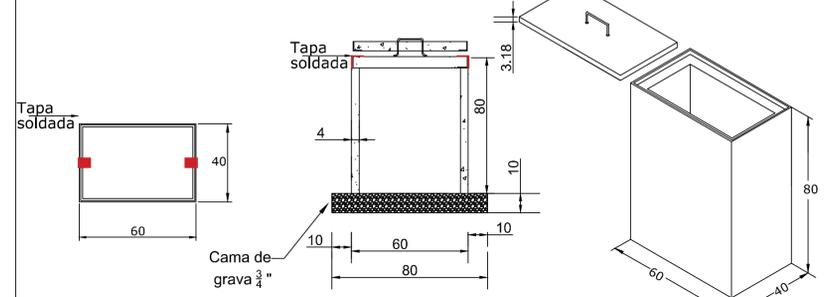
Registro precolado 40X60X80 cm, con marco y contramarco galvanizado por inmersión en caliente. Fabricado con concreto hidráulico F' C= 200 Kg/cm2, registro armado con malla 6X6-10/10 en muro y malla 6X6-6/6 en tapa, muros de 4 cm de espesor con acabado cemento pulido, marco con ángulo de 1-1/2" X 1/4" y espesor de 3.18 cm. Incluye: agarradera para la tapa elaborado en acero redondo de 3/4" galvanizado por inmersión en caliente, rondanas y tuercas de 3/4" galvanizadas para su sujeción.
