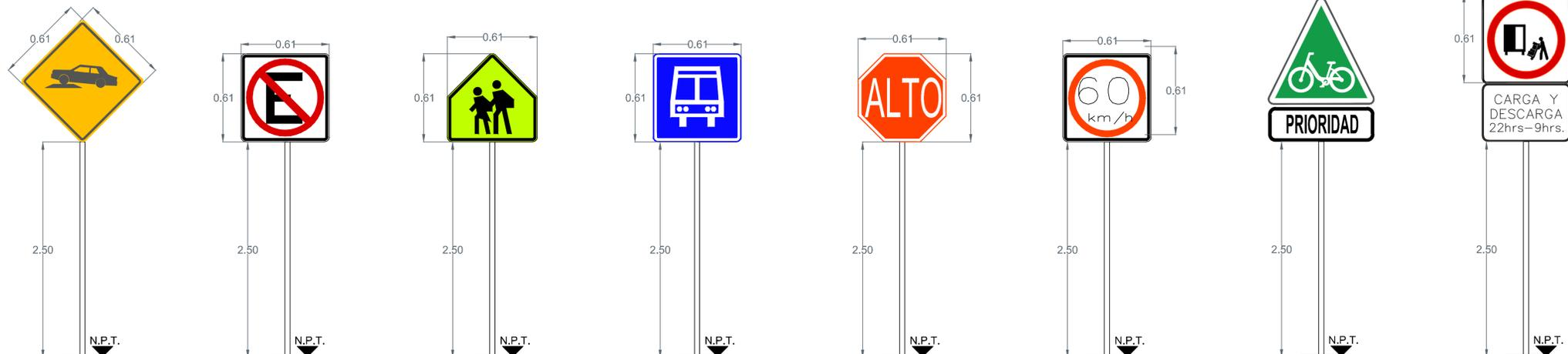
SP-41 reductor de velocidad: Se usa para indicar la proximidad de un reductor de velocidad, que es un dispositivo instalado sobre la superficie de rodadura para controlar la velocidad de los vehículos. Ubicar 40 m. Antes del cruce sobre la banqueta derecha conforme al sentido vehicular.
