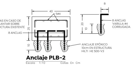
detalle de anclaje a losa nueva
