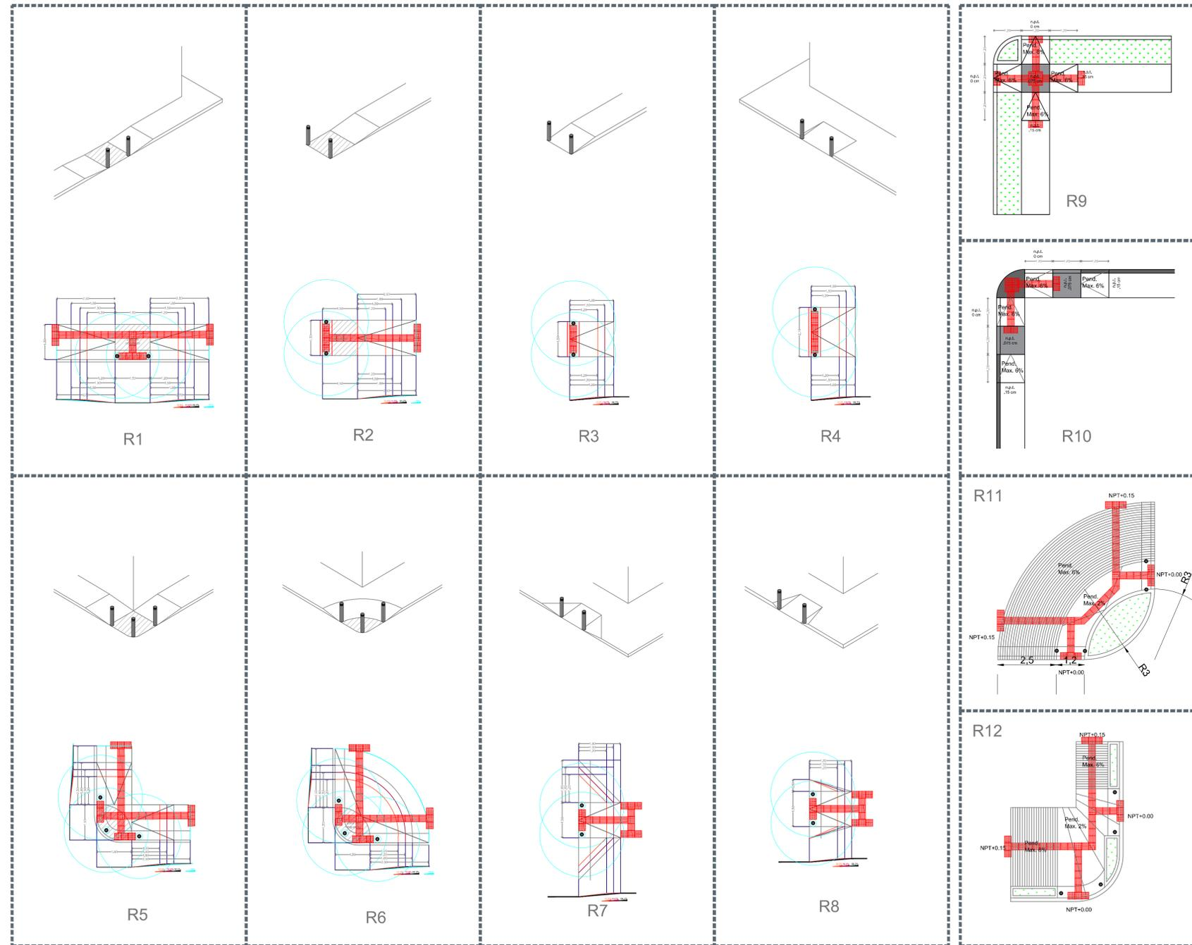
**ESPECIFICACIÓN:** Loseta vibro-prensada prefabricada con textura táctil puntual o lineal en formato 40 cm x 40 cm x 5 cm de espesor, de uso peatonal, con resistencia a la compresión f'c=250kg/cm<sup>2</sup>, acabado aparente, con sellador base acrílico silano siloxano libre de solventes.
