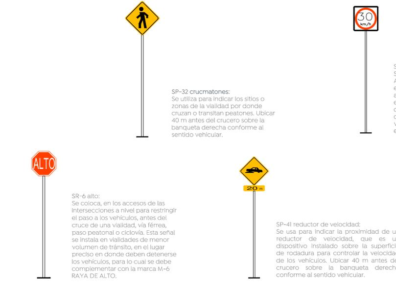
**2** Detalles de señales verticales Escala 1:40
