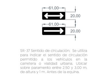
SR-37 Sentido de circulación: Se utiliza para indicar el sentido de circulación permitido a los vehículos en la carretera o vialidad urbana. Ubicar sobre paramento entre 2.50 y 3.00 m. de altura y 1 m. Antes de la esquina.
