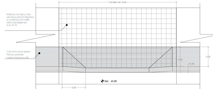
Banqueta de concreto f'c= 200 kg/cm<sup>2</sup> de 10 cm de espesor, con malla electrosoldada 6x6/10-10, en área de banquetas en cocheras, acabado escobillado.
