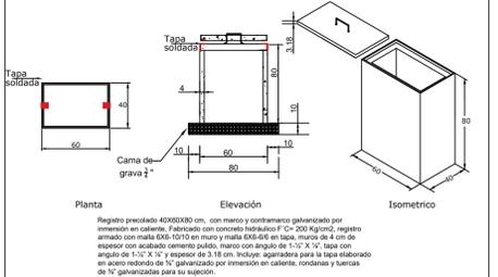
Las tapas deberán ser soldadas para evitar robos de accesorios; y deberán ser soldadas después de la supervisión por parte de la Dirección de Alumbrado Público.
