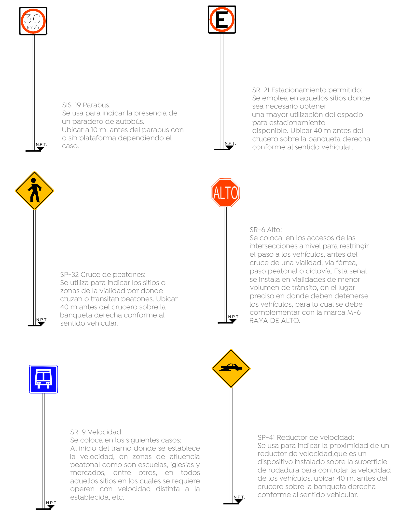
2 Detalles de señales verticales Escala 1:40
