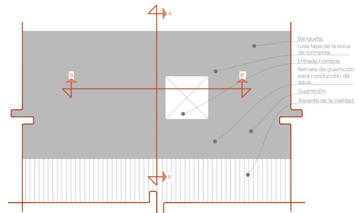
Planta pozo de infiltración prefabricado
