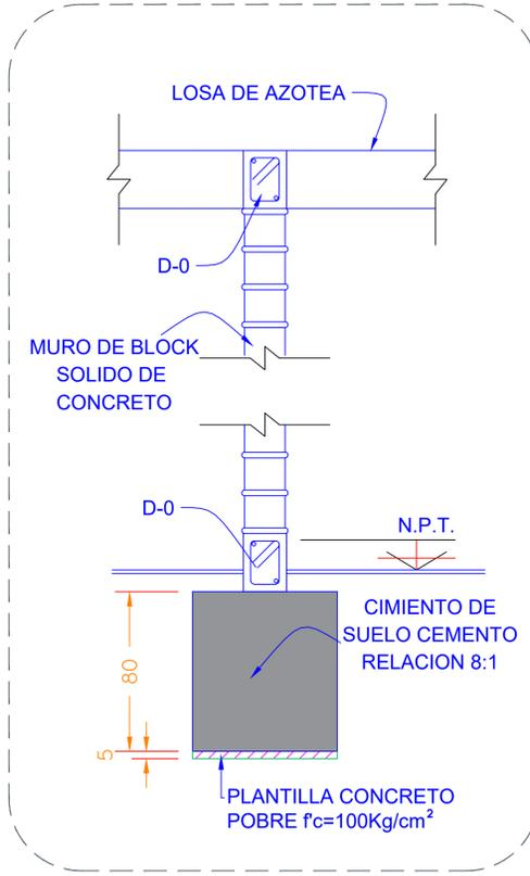
05 Sección tipo de muro
