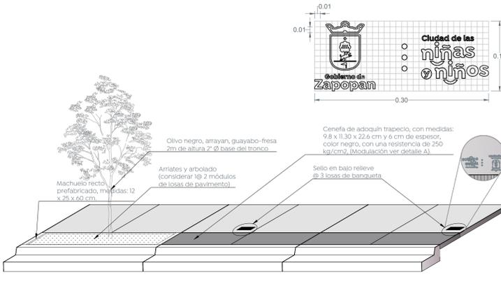
3 Detalle de configuración de banquetas Escala 1:50
