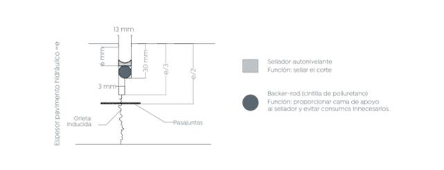
8 Detalle de junta constructiva Escala 1:2
