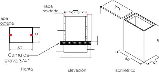
Registro precolado 40x60x80 cm, con marco y contramarco galvanizado por inmersión en caliente, fabricado con concreto hidráulico F'c= 200 Kg/cm<sup>2</sup>, registro armado con malla 6X6-10/10 en muro y malla 6X6-6/6 en tapa, muros de 4 cm de espesor con acabado cemento pulido, marco con ángulo de 1-1/2" X 1/8" y espesor de 3.18 cm. Incluye: agarradera para la tapa elaborado en acero redondo de 3/8" galvanizado por inmersión en caliente, rondanas y tuercas de 3/8" galvanizadas para su sujeción.
