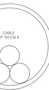
Cálculo ocupación de tubería de cable 2+1, calibre 4 en tubería de 2"
