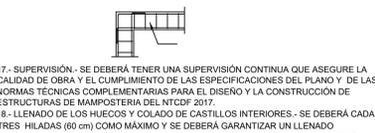
16.- ANCLAJE DEL REFUERZO DE DALAS - EL ANCLAJE DEL REFUERZO LONGITUDINAL DE LAS DALAS DEBERÁ HACERSE EN EL PLANO HORIZONTAL EN LA DALA PERPENDICULAR.
