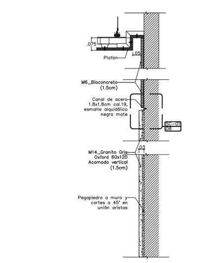
04 ACABADO: MURO GRANITO / BIOCONCRETO
