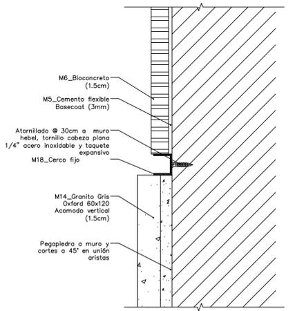
08 DETALLE GRANITO - BIOCONCRETO
