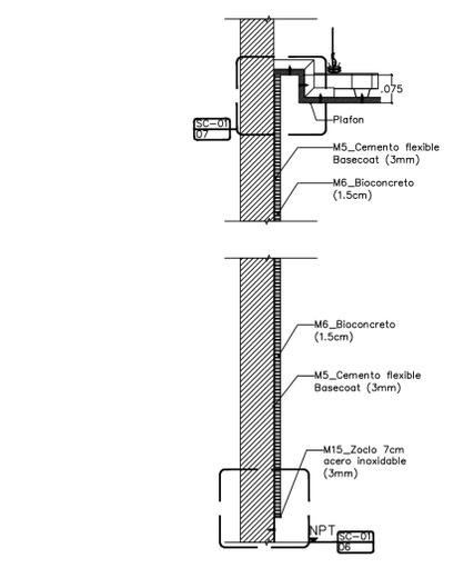
05 ACABADO: MURO BIOCONCRETO
