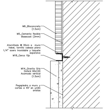
08 DETALLE GRANITO - BIOCONCRETO
