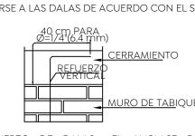
16.- ANCLAJE DEL REFUERZO DE DALAS.- EL ANCLAJE DEL REFUERZO LONGITUDINAL DE LAS DALAS DEBERÁ HACERSE EN EL PLANO HORIZONTAL EN LA
