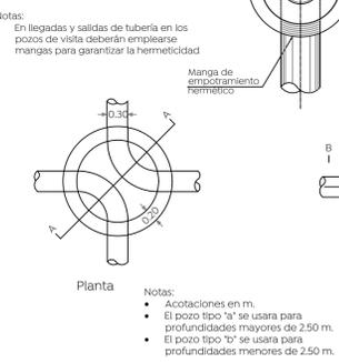
Armado en dalas para pozos de vista, según profundidad
