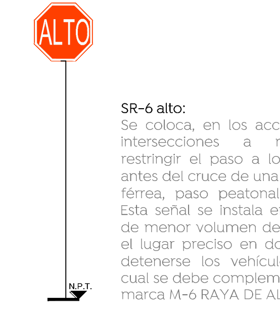
SR-6 alto: Se coloca, en los accesos de las intersecciones a nivel para restringir el paso a los vehículos, antes del cruce de una vialidad, vía férrea, paso peatonal o ciclovia. Esta señal se instala en vialidades de menor volumen de tránsito, en el lugar preciso en donde deben detenerse los vehículos, para lo cual se debe complementar con la marca M-6 RAYA DE ALTO.
