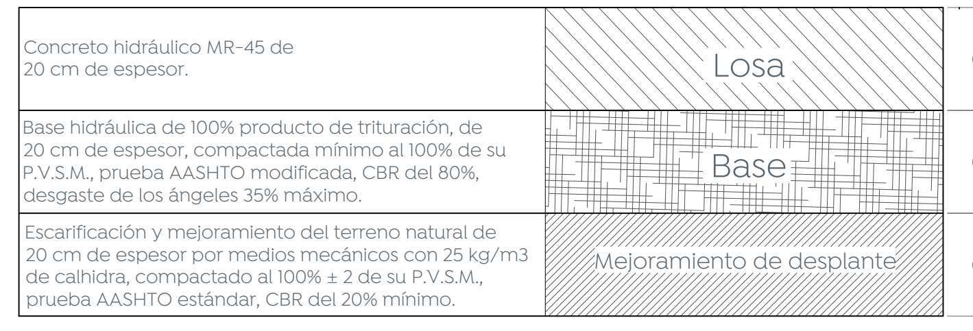
2 Conformación de pavimento Escala 1:10
