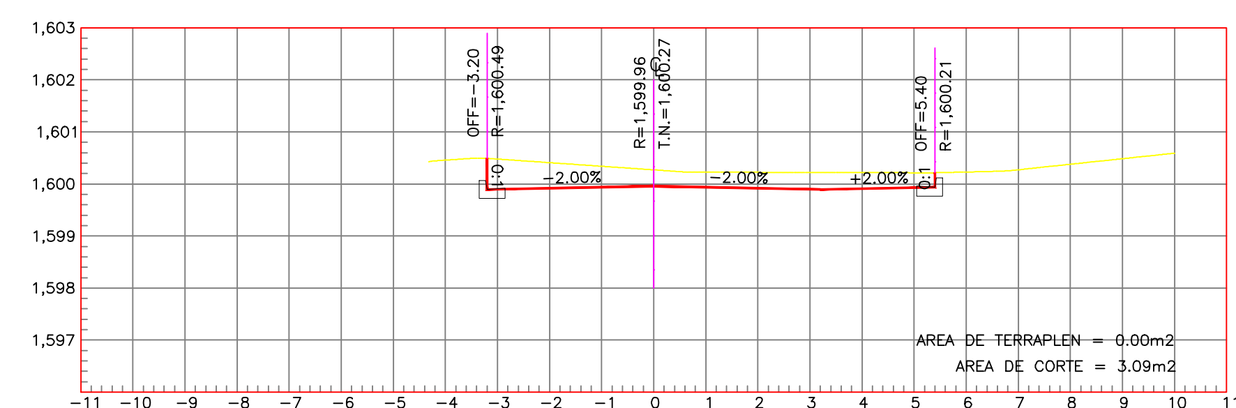
ESTACION O+340.00 ESCALA HORIZONTAL 1 : 100 ESCALA VERTICAL 1 : 100
