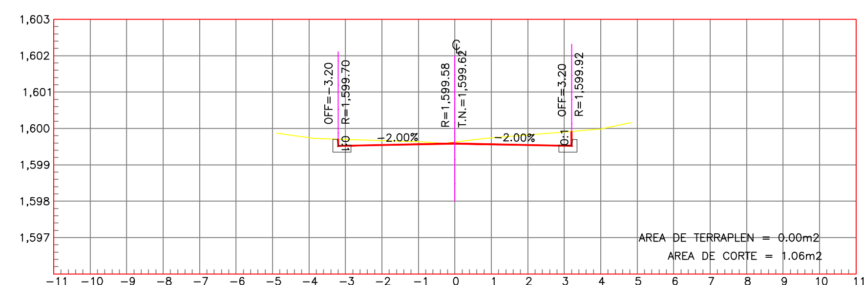
ESTACION O+240.00 ESCALA HORIZONTAL 1 : 100 ESCALA VERTICAL 1 : 100
