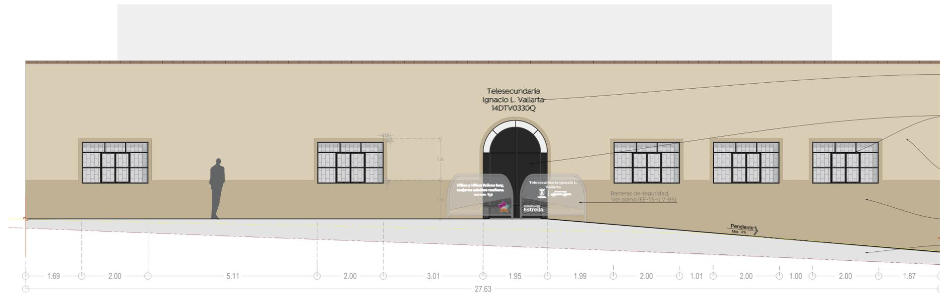
Letrero en alto relieve con elementos individuales, cortados con láser, fabricados en placa de acero 3/16". Pintura de esmalte acrílico de comex color negro mate. Protección con recubrimiento de barniz transparente de poliuretano. Preparación de anclas de 15 cm fabricadas con sólido inox 1/4" para ser fijadas a muro con 5 cm de separación con adhesivo epóxico Sika AnchorFix color gris. Fuente tipo Isidora, h=15 cm.
