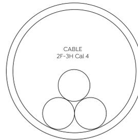
Diámetro de tubería: 51mm (2"Ø)
