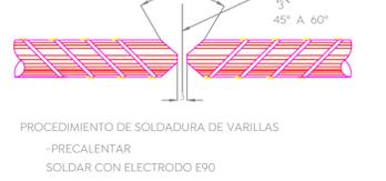
PROCEDIMIENTO DE SOLDADURA DE VARILLAS
