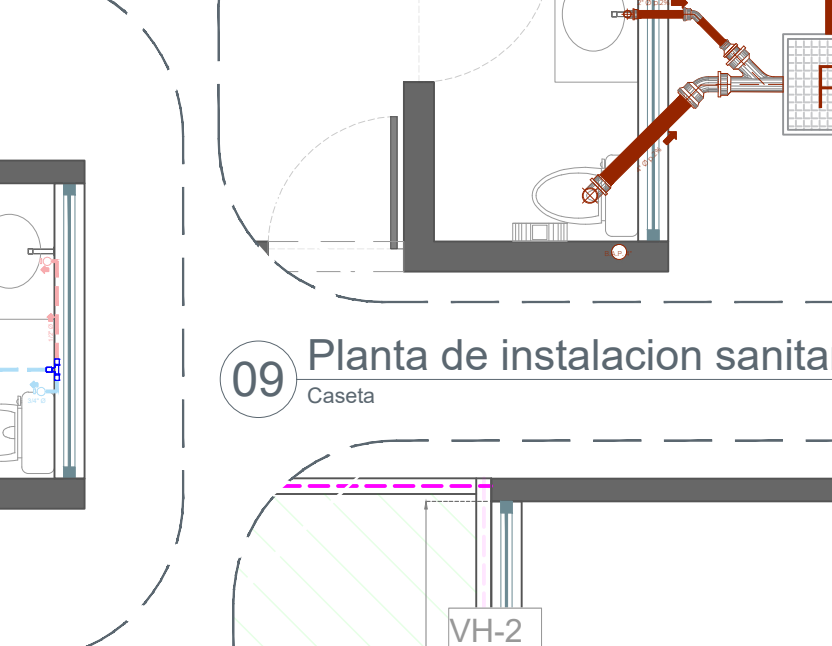
09 Planta de instalacion sanitaria Caseta 1:50
