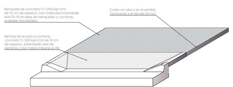
4 Detalle de rampas de cocheras Escala 1:25
