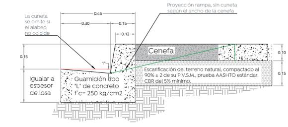
1 Detalle de guarnición Escala 1:10
