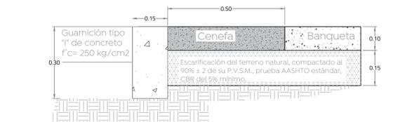
08 Detalle de guarnición Escala 1:10
