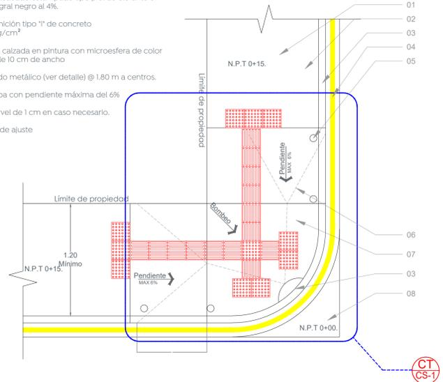
**ESPECIFICACIÓN:** Loseta vibro-prensada prefabricada con textura táctil puntual ó lineal en formato 40 cm x 40 cm x 4 cm de espesor, de uso peatonal, con resistencia a la compresión  $f'c=250\text{kg/cm}^2$ .
