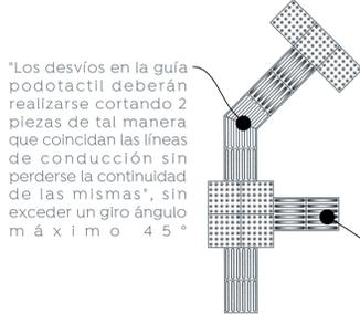
"Los desvíos en la guía podotáctil deberán realizarse cortando 2 piezas de tal manera que coincidan las líneas de conducción sin perderse la continuidad de las mismas", sin exceder un giro ángulo máximo 45°
