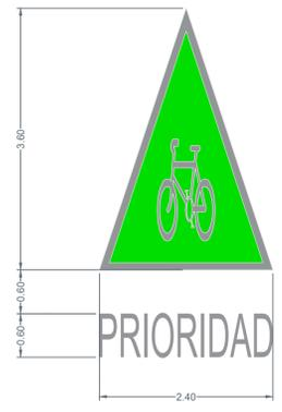
2 Detalles de señales verticales Escala 1:40
