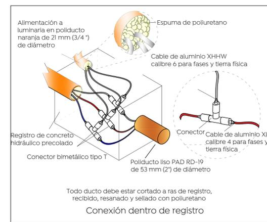
08 Conexión dentro de registro Escala S/E
