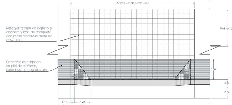
Banqueta de concreto f'c=200 kg/cm² de 10 cm de espesor, con malla electrosoldada 6x6/10-10 en área de banquetas y cocheras, acabado esnobillado
