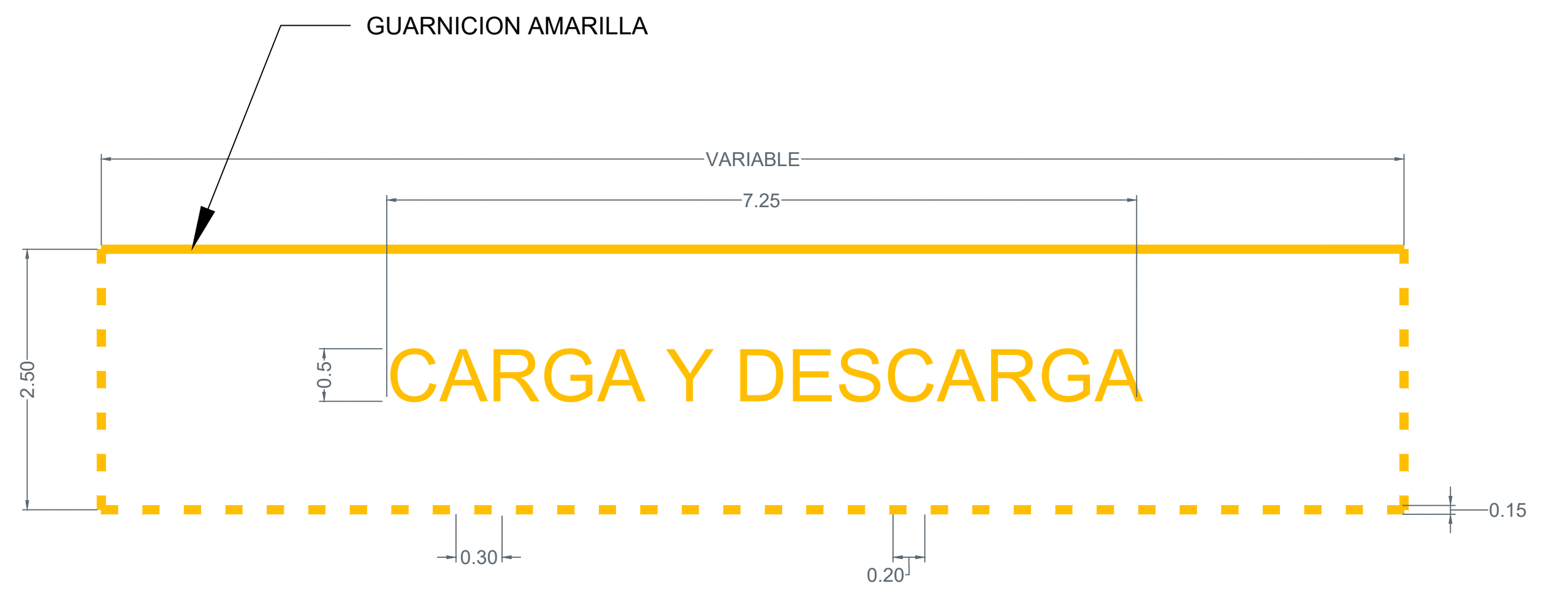
3 Detalle carga y descarga acotaciones en metros
