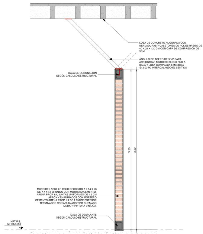
**5 Detalle sección muro de block interior**
