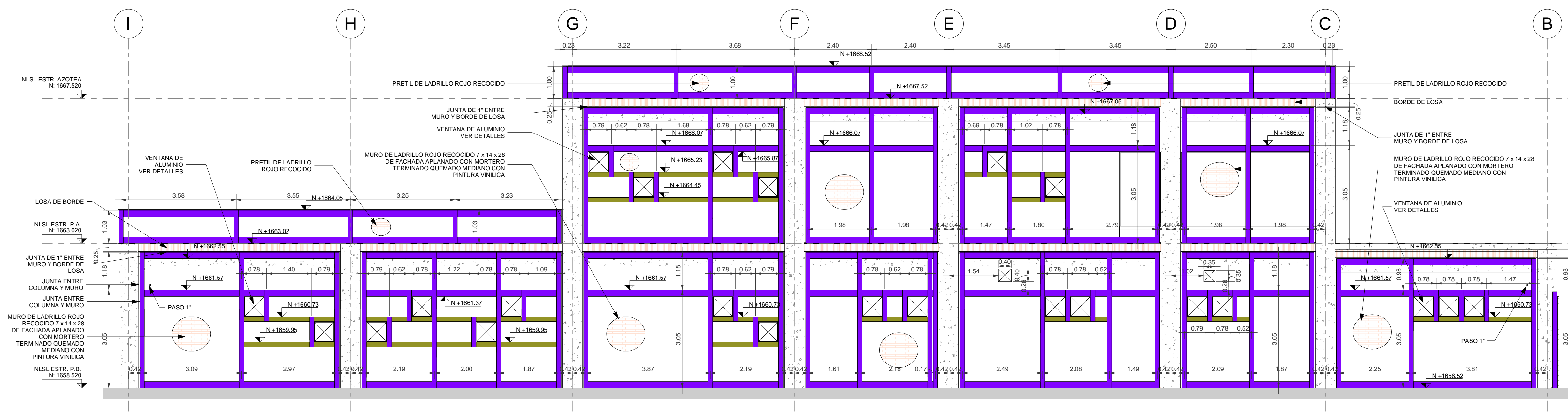
1 ALZADO MURO BLOCK EJE 1 ESCALA 1 : 75
