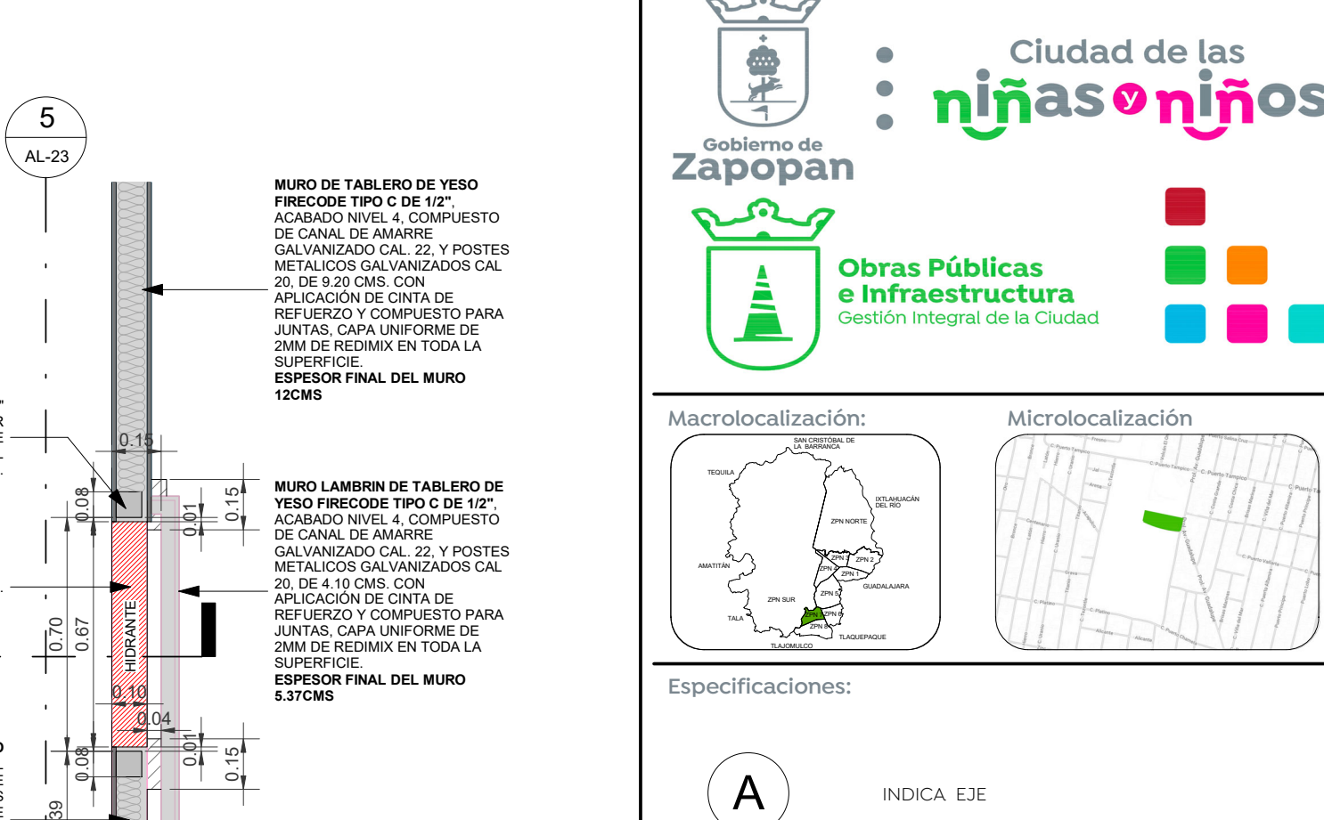
4 DETALLE. HIDRANTE ESCALA 1 : 20
