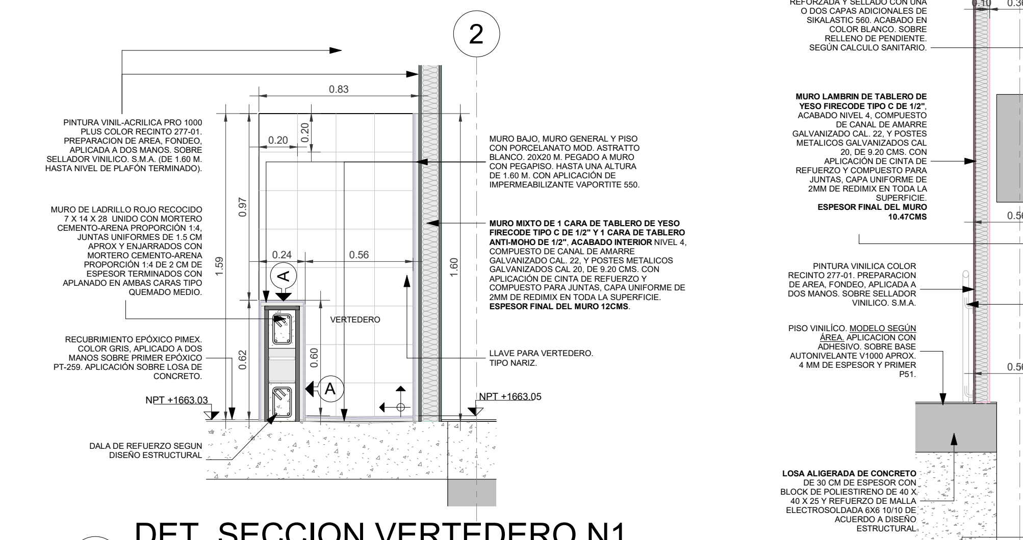
6 DET. SECCION VERTEDERO N1 ESCALA 1:20
