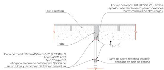
**Detalle tipo fijación muro tapón a losa, nervadura o trabe**
