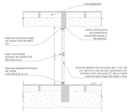
**06a Sección Vertical de Muro Tapón Sótano**
