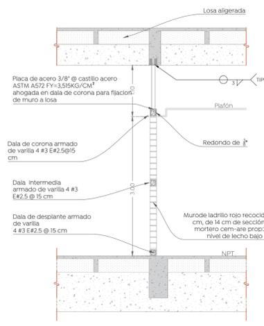
**06 Sección Vertical de Muro Tapón**
