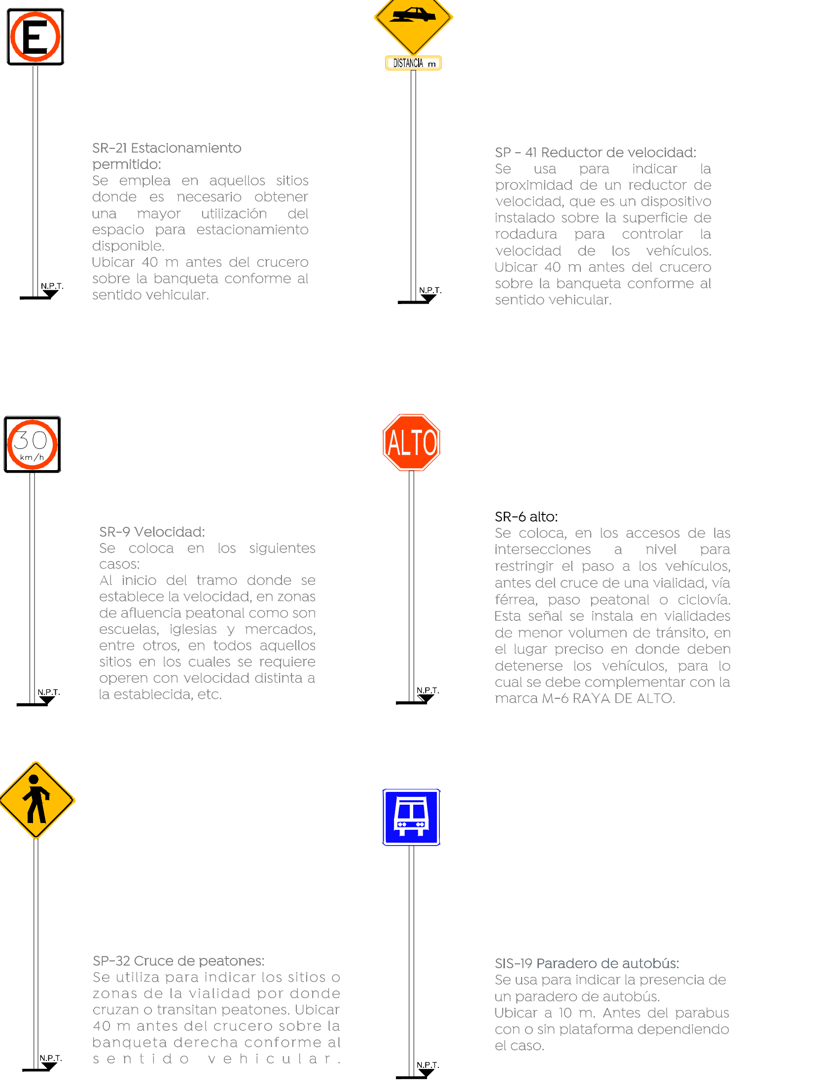
Distancia lateral y Altura de las Señales Verticales en Zona Urbana
