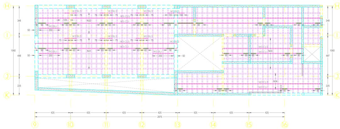
**Planta estructural de azotea, armados de nervaduras longitudinales**
