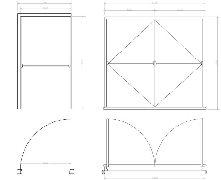
**PH-01** Puerta metálica de emergencia doble, medidas vano libre 120 x 220 mts (alto x ancho) (vano libre), incluye, barra antipánico de dos puntos, doble cerraduras potencia 4, resistencia al fuego por 180 minutos, relleno interior en lamina mineral, terminada en pintura electrostática color a elección del cliente
