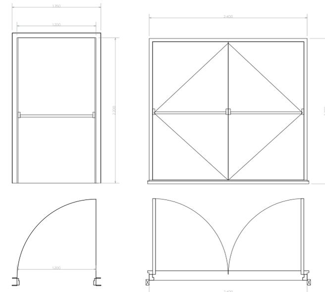
**PH-01** Puerta metálica de emergencia doble marca armor high, medidas vano libre 2.40 x 2.20 mts (alto x ancho) (vano libre). Incluye, barra antipánico de dos puntos, doble cierrapuertas potencia 4, resistencia al fuego por 180 minutos, relleno interior en lamina mineral, terminada en pintura electrostática color a elección del cliente
