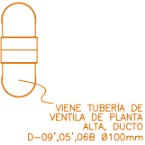
Ducto D-09',05',06B Esc. 1:10
