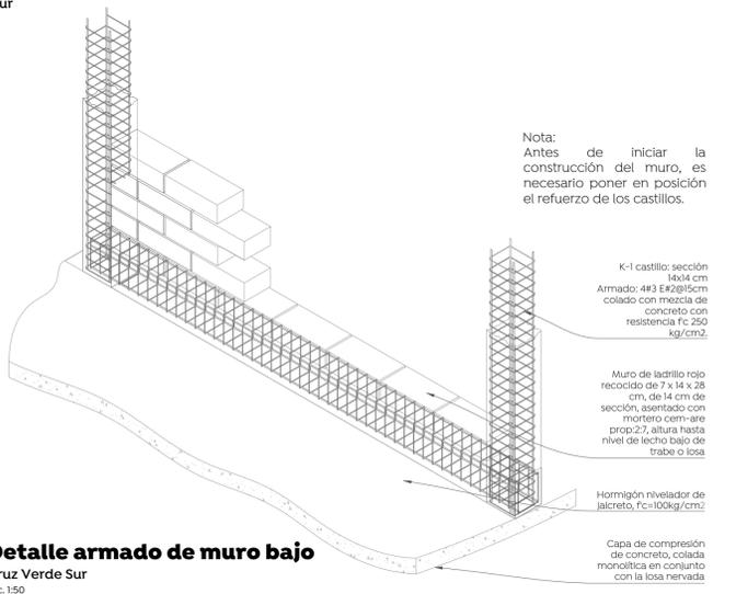
**Detalle armado de muro bajo**
