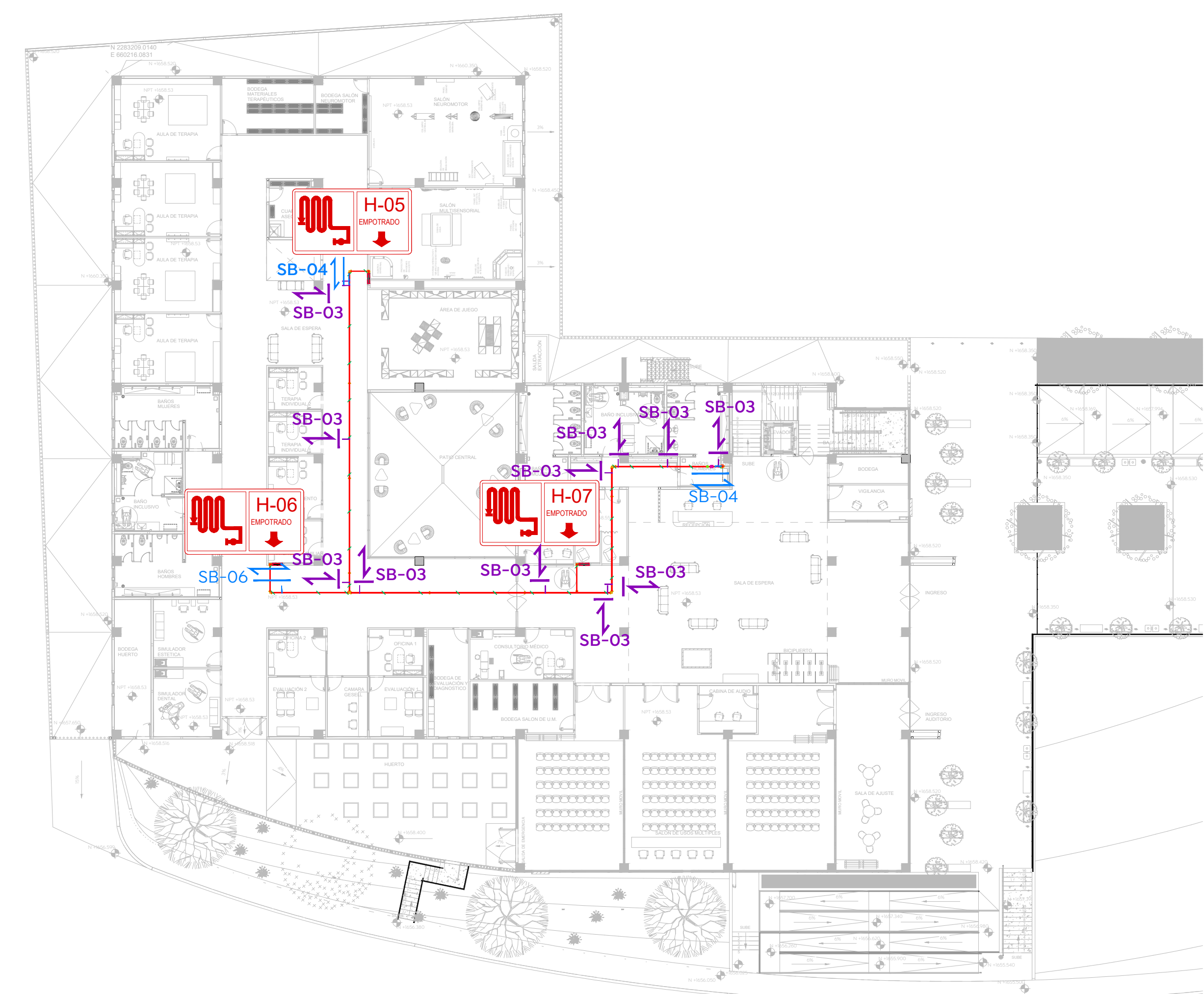
Planta Baja Planta Soportes Antisísmos Esc. 1:250
