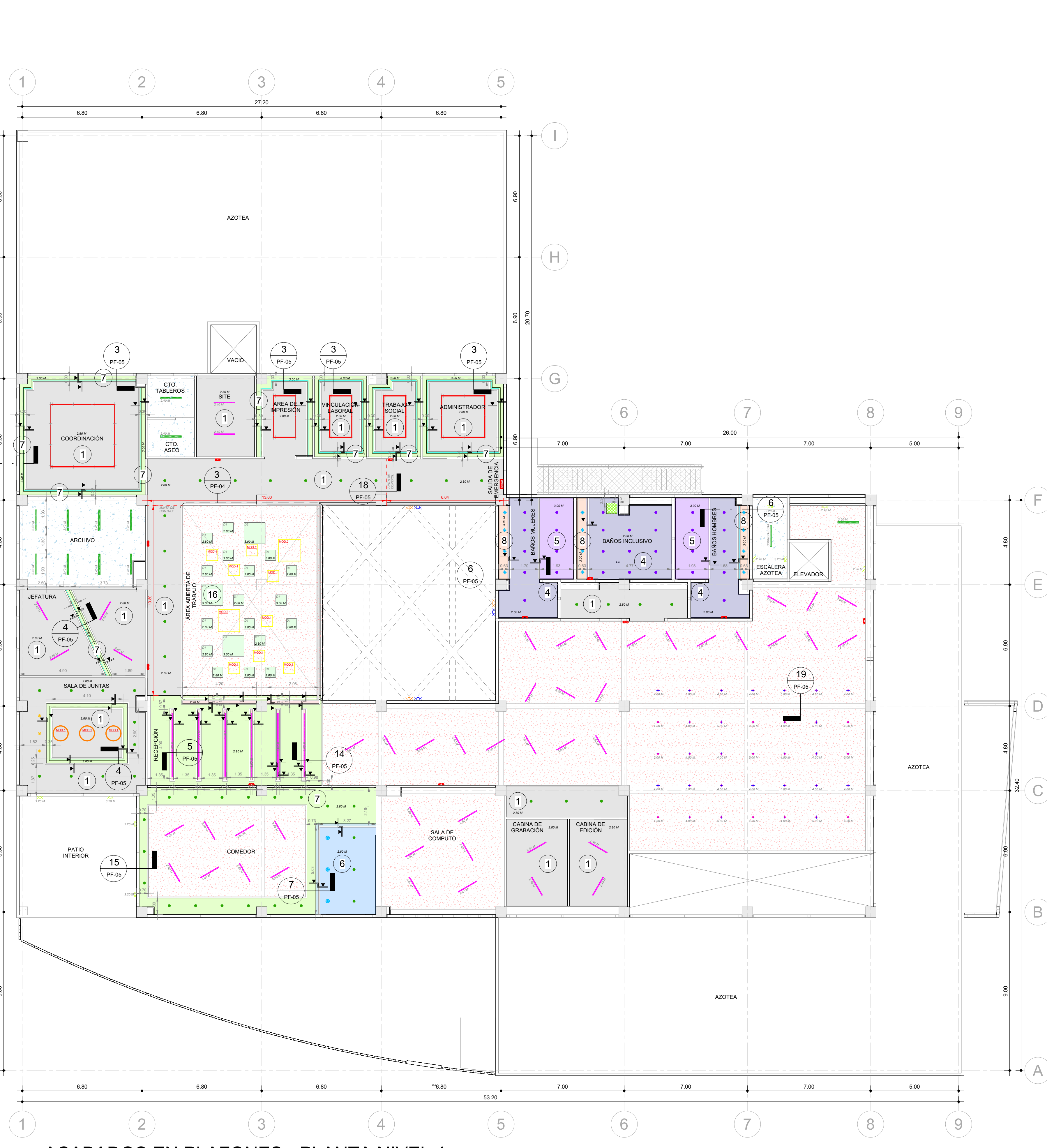
1 ACABADOS EN PLAFONES - PLANTA NIVEL 1 ESCALA 1 : 125
