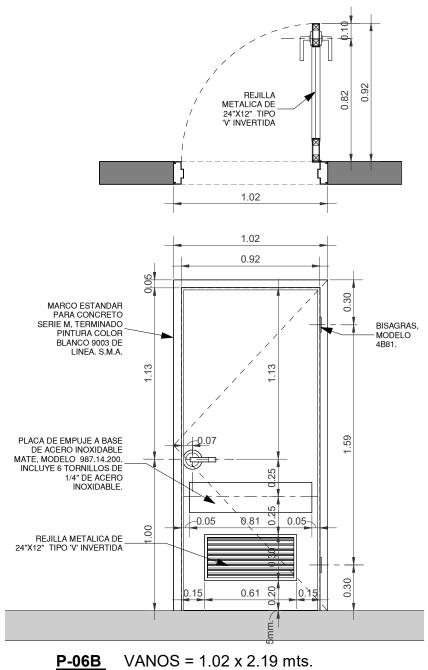
PUERTA DE 1.02 X 2.19MTS, PREFABRICADA, FABRICADA CON LAMINA DE ACERO ROLADA EN FRIO CAL.18 ALMA DE POLIESTIRENO EXPANDIDO ESTILO "L", CON MARCO ESTANDAR PARA CONCRETO SERIE M, NO INCLUYE ETIQUETA CONTRA FUEGO. ACABADO CON PRIMER ANTICORROSIVO COLOR BLANCO. 1 CHAPA CON MANIVELA MOD. SLCHKE26D. 2 BISAGRAS, MODELO 4B81. 1 PLACA DE EMPUJE, MODELO 987.14.200.
