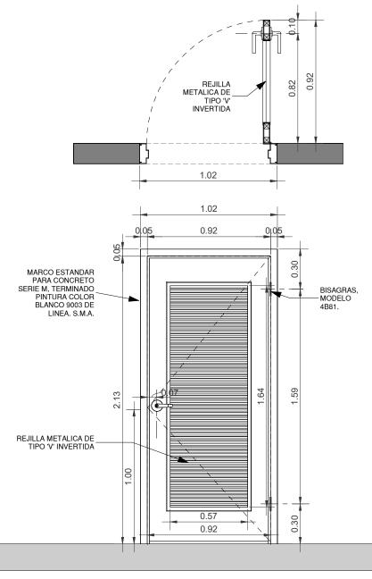
**P-02B** VANOS = 1.02 x 2.19 mts. PUERTA DE 1.02 X 2.19MTS, PREFABRICADA, FABRICADA CON LAMINA DE ACERO ROLADA EN FRIO CAL.18 ALMA DE POLIESTIRENO EXPANDIDO ESTILO "L", CON MARCO ESTANDAR PARA CONCRETO SERIE M. ACABADO CON PRIMER ANTICORROSIVO COLOR BLANCO 9003 DE LINEA. 1 CHAPA CON MANIVELA MOD. SLCHKE26D. 2 BISAGRAS, MODELO 4B81. 1 REJILLA METALICA DE TIPO 'V' INVERTIDA. 1 TOPE DE PISO MEDIA LUNA - ACERO INOXIDABLE 304 - (Alt. 28mm) MOD. CMD001
