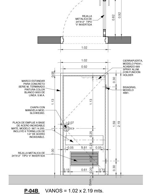
PUERTA DE 1.02 X 2.19MTS, PREFABRICADA, FABRICADA CON LAMINA DE ACERO ROLADA EN FRIO CAL.18 ALMA DE POLIESTIRENO EXPANDIDO ESTILO "L", CON MARCO ESTANDAR PARA CONCRETO SERIE M, NO INCLUYE ETIQUETA CONTRA FUEGO. ACABADO CON PRIMER ANTICORROSIVO COLOR BLANCO.
